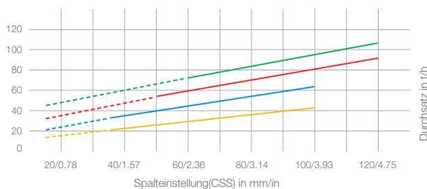
\* Die Durchsatzleistung variiert zwischen Material, Aufgabegröße und Spalteinstellung. Die dargestellte Durchsatzleistung ist für mittleres bis hartes Material unter optimalen Bedingungen und unter Berücksichtigung der Schwen-
